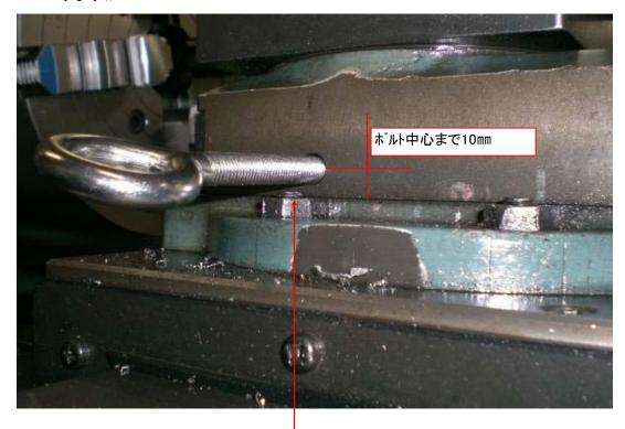
複式刃物台に、この様な長いボルトを取り付けても 角度調整用のボルトナットに当たらない。
